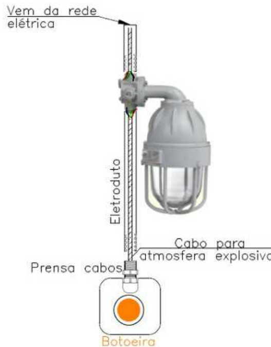
Conexão do conjunto
