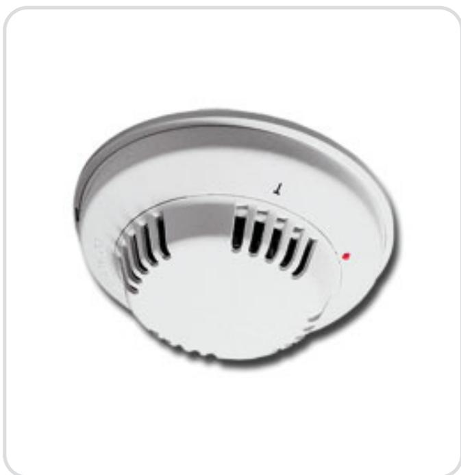
O D260 e o D270 são uma série de detectores de fumaça fotoelétricos, de baixo perfil, cujo desenho patenteado da câmara provê imunidade superior aos falsos alarmes gerados pela poluição ambiental. O processo de auto-diagnóstico da câmara permite verificar a sensibilidade do detector através de uma simples observação da frequência em que o LED no detector pisca.
