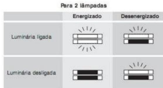
Quando o interruptor é acionado as 2 lâmpadas são energizadas, se houver falta de energia permanece somente uma lâmpada acesa.
